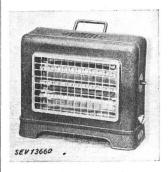
Beschreibung: Heizstrahler gemäss Abbildung, mit zwei übereinander angeordneten Heizelementen. Letztere bestehen aus Widerstandsspi-ralen, die auf Stäbe aus keramischem Material gewickelt sind. Hinter jedem Heizelement befindet sich ein Blechreflektor. In der Zuleitung zum oberen Heizelement befindet sich ein Schalter. Zum ganzen Ausschalten  $\mathbf{des}$
