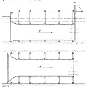
Fig. 12. Provisorische Holzdüse mit quadratischem oder rechteckigem Querschnitt
