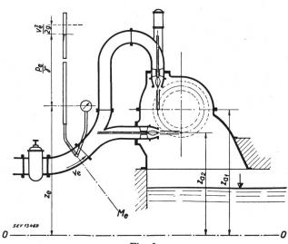
Fig. 9. Gleichdruckturbine Zweidüsig. Horizontale Welle. Nutzgefälle  $H=z_e-\frac{z_{a_1}+z_{a_2}}{2}+\frac{p_e}{1\gamma}+\frac{v_e^2}{2g}$
