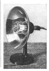
Beschreibung: Heizstrahler gemäss Abbildung, mit Blechreflektor von 270 mm Durch-messer. Widerstandsdraht auf zylindrischen Körper aus keramischem Material gewickelt und gegen zufällige Berührung geschützt. Strahler auf einem Fuss aus Isolierpreßstoff befestigt, Neigung verstellbar. Apparatestecker für den Anschluss der Zuleitung. Der Heizstrahler hat die
