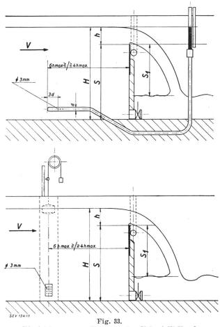
Einrichtungen zur Messung der Ueberfallhöhe h
