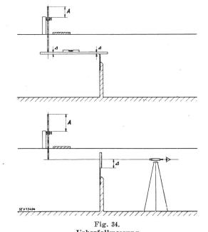
Ueberfallmessung Einstellung des Stechpegel-Nullpunktes mit Wasserwaage (oben) oder Nivellierinstrument (unten)
