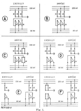
Kombination verschiedener Schaltungen von Einphasen-Transformatoren 220/60 kV
