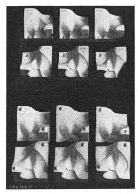
Fig. 17. Gipskontrollformen für Wassermessflügel
