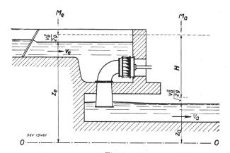
Fig. 1. Ueberdruckturbine (Francis, Propeller, Kaplan)
