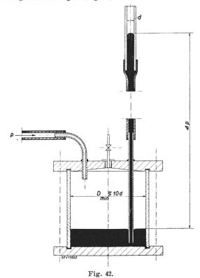
Druckmessung: Quecksilber-Druckmesstopf mit Steigrohr p Druckzuleitung. d Lichter Durchmesser des Piezometer-Glasrohres.  $\Delta p$  Druckdifferenz
