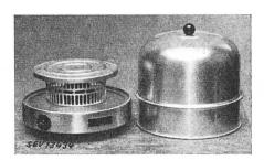
Beschreibung: Backofen gemäss Abbildung. Im Unterteil ist ein Heizkörper eingebaut. Dieser besteht aus einer Widerstandsspirale, welche auf einen kegelförmigen Körper aus keramischem Material gewickelt und durch ein perforiertes Eisenblech vor zufälliger Berührung geschützt ist. Regulier-Wärmeschalter und Apparatestecker eingebaut. Der Zwischenring und die Haube bestehen aus Aluminiumblech
