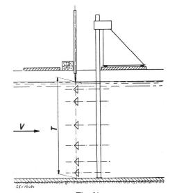
Fig. 24. Messung der Wassertiefe im Flügelmessquerschnitt mit Stechpegeln
