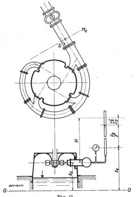
Fig. 11. Gleichdruckturbine Mehrdüsig. Vertikale Welle.
