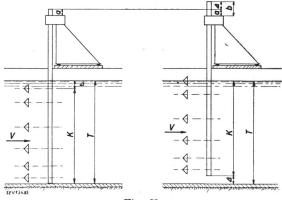
Fig. 25. Messung der Wassertiefe im Flügelmessquerschnitt durch Anheben der Flügelstange
