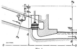
Fig. 4. Ueberdruckturbine
