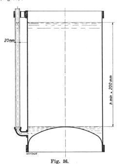
Behältermessung Normalform eines transportablen Messbehälters und Ausbildung des Piezometer-Rohres
