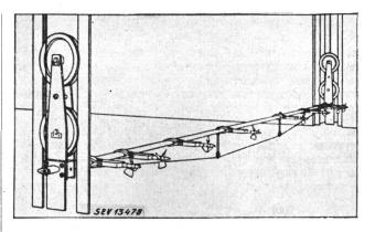
Fig. 18. Einfacher, horizontaler Flügelmessrahmen, Konstruktion Ott
