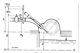
Gleichdruckturbine (Freistrahl, Pelton)
