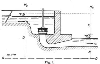
Ueberdruckturbine Offene Wasserkammer. Vertikale Welle. Saugrohrkrümmer.  $v_e^2 - v_a^2$ Nutzgefälle  $H = z_e$
