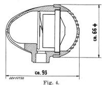
Gehäuse des Kommandomikrophons mit eingebautem auswechselbarem System
