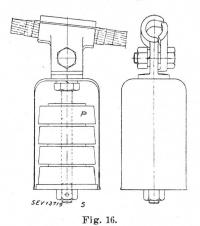
l'action des forces verticales, qui changent rapidement de sens et leur communiquent un mouvement sautillant, de sorte qu'ils s'entrechoquent et se heurtent contre la plaque. L'énergie oscillatoire du conducteur est ainsi absorbée par les poids, sous forme de travail de déformation ou de chaleur. Cet amortisseur ne peut pas entrer en résonance avec les oscillations du conducteur, car sa masse varie avec le nombre des poids qui pèsent sur le conducteur.
