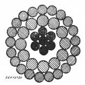
Fig. 17. Construction d'un conducteur antivibratoire
