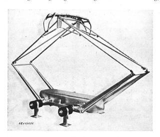
Fig. 3. Stromabnehmer, Bauart Brown Boveri, in Fahrstellung
