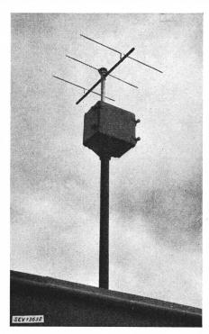
Fig. 12. **Richtstrahl-Antenne** vereinfachte Ausführung
