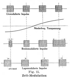
steht darin, dass hochfrequente Impulspakete variabler zeitlicher Länge oder variabler Verzögerung emittiert werden. Die Impulslänge oder die Verzögerungszeit steht in der Regel in linearer Beziehung zum «momentanen» Wert der Modulationsspannung, wobei man unter «momentan» allerdings verschiedenes verstehen kann. Fig. 15 zeigt zwei Möglichkeiten der ZM, welche man übrigens in sehr zutreffender Weise als «telegraphierte» Sprache oder Musik bezeichnen kann.
