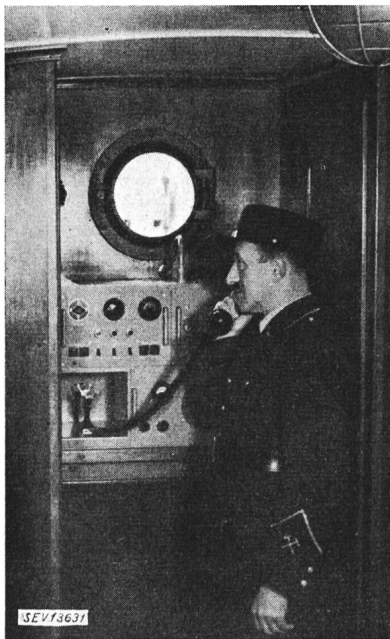
Fig. 11. FM-Funkstation in einem Löschboot der Basler Feuerwehr
