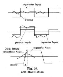
Kanten bedingt aber sehr breite Frequenzbänder, die in der Praxis beschnitten werden müssen. Dies hat zur Folge, dass man weniger steile Flanken erhält. Während der «Flankenzeit»  $\tau$  bewirkt dann die Störung eine geringe Verschiebung der Kante.
