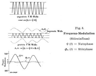
Da sich die Störung vor allem in der Amplitude und nur zu wenigen Prozenten in der Phase, resp. Frequenz auswirkt, kann der Störeinfluss zum grössten Teil reduziert werden, wenn wir die Amplitude wieder auf einen konstanten Wert bringen. Diese Aufgabe besorgt im FM-Empfänger der Amplituden-Begrenzer.
