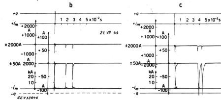
Fig. 8. oscillogrammes courant de foudre de brève durée
