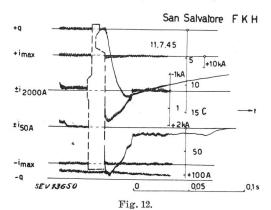
Oscillogramme d'un courant de foudre avec une décharge partielle négative et une décharge positive
