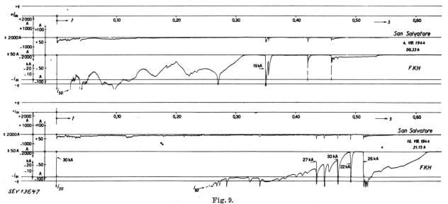
Deux oscillogrammes de courant de foudre de faible intensité et de longue durée avec courant de choc superposés
