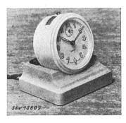
Beschreibung: Wecker mit Holzfuss, in welchem 2 einpolige Kipphebelschalter und eine zweipolige Kupplungssteckdose den Anschluss des ein- oder auszuschaltenden Apparates eingebaut sind. Einer der beiden Kipphebelschalter wird beim Ablaufen des Läutwerkes durch dessen Aufzugschlüssel eingeschaltet. Der zweite Kipphebelschalter wird durch einen
