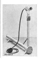
Beschreibung: Tauchsieder gemäss Abbildung, zum Erwärmen von Tränkewasser in einem Brunnentrog. Heizelement mit Keramikisolation in verzinktes Eisenrohr Durchmesser mm und 1090 mm Länge eingebaut. Anschlussleitungen durch ein Eisenrohr zugeführt, an dessen oberem Ende ein Gussgehäuse mit eingebautem Drehschalter angebracht ist. Netzanschluss mit vieradriger, mit 3 P + E-Stecker versehener Apparate-
