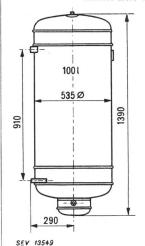
Beschreibung: Heisswasserspeicher für Wandmontage gemäss Skizze. Ein Heizelement, ein Temperaturregler mit Sicherheitsvorrichtung und ein Zeigerthermometer eingebaut.
