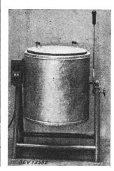
Beschreibung: Futterkocher gemäss Abbildung, aus verzinktem Eisenblech, auf Gestell zum Kippen eingerichtet. Bodenheizung. Klemmenkasten mit Regulierschalter und Signallämpchen seitlich angebracht. Vieradrige Zuleitung (3 P+E) fest angeschlossen. Isoliergriffe am Deckel, an der Kippstange und der Feststellvorrichtung.
