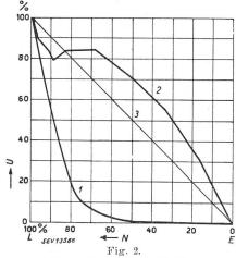
Spannuagsverteilung längs einer Wicklung von 13 750 V, bei einem aufgedrückten Spannungsstoss 1,6 | 37
