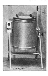
Beschreibung: Futterkocher gemäss Abbildung, auf Gestell zum Kippen eingerichtet. Behälter aus verzinntem Kupfer, Aussenmantel aus verzinktem Eisenblech. Bodenheizung. Klemmenkasten und Regulierschalter seitlich angebracht. Stopfbüchse für Leitereinführung. Handgriffe aus Isolierpreßstoff.
