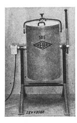
Beschreibung: Futterkocher gemäss Abbildung, aus verzinktem Eisenblech, auf Gestell zum Kippen eingerichtet. Bodenheizung. Deckel mit Spannvorrichtung und Sicherheitsventil versehen. Regulierschalter seitlich angebracht und durch Blechverschalung schützt. Dreiadrige Zuleitung (2 P+E) fest angeschlossen. Handgriffe aus Isoliermaterial.
