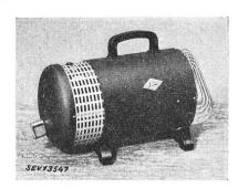
Temperatursicherung unterbricht den Stromkreis, sobald infolge ungenügender Ventilation zu hohe Temperaturen auftreten. Eingebauter Kipphebelschalter ermöglicht Betrieb des Ofens mit halber oder ganzer Leistung. Apparatestecker für den Anschluss der Zuleitung.
