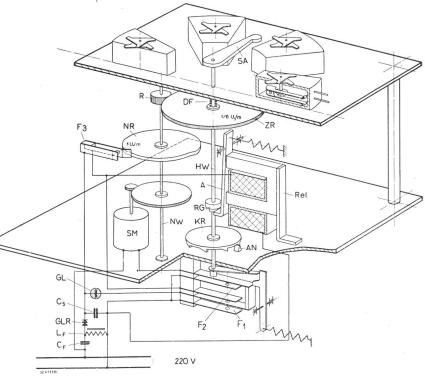
Zahnrädergetriebe die Welle NW mit dem Nockenrad NR, ferner über das Ritzel R und das Zahnrad ZR die Hauptwelle HW. Das heisst: nach einem sogenannten Startimpuls beginnt sich die Hauptwelle HW mit dem Schaltarm SA wunschgemäss zu drehen.
