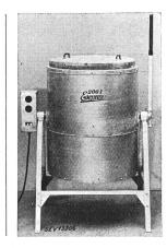
Beschreibung: Futterkocher gemäss Abbildung, aus verzinktem Eisenblech, auf Gestell zum Kippen eingerichtet. Boden- und Seitenheizung, durch zwei Schalter einzeln einschaltbar. Klemmen- und Schalterkasten seitlich angebracht. Vieradrige Zuleitung (3 P+E) fest angeschlossen. Isolierhandgriffe an der Kippstange und am Deckel.
