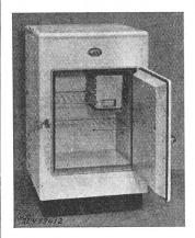
Beschreibung: Haushaltungs-Kühlschrank gemäss Abbildung. Periodisch arbeitendes Absorptions-Kühlaggregat mit Luftkühlung auf der Rückseite ange-bracht. Steuerung durch zwei im Kocher eingebaute Temperaturregler und ein unten am Schrank angebrachtes Schütz. Schublade für Eisbereitung im Verdampfer. Netzanschluss mit dreiadriger Schnur 2 P + E-Stecker.
