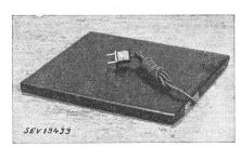
Beschreibung: Fusswärmeplatte aus Kunststein gemäss Abbildung. Heizwiderstand eingegossen. Filzstreifen an der Unterseite. Zweiadrige Rundschnur mit Stecker fest angeschlossen und durch Bride an der Platte festgehalten.
