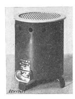
Beschreibung: Heizofen gemäss Abbildung. Widerstandsspirale auf zylindrischen Körper aus keramischem Material gewickelt und in ventiliertes Blechgehäuse von 110 mm Durchmesser und 120 Höhe eingebaut. Höhe der Füsse 20 mm. Das Gehäuse ist oben durch ein Drahtgitter abgeschlossen. Apparatestecker für den Anschluss der Zuleitung.
