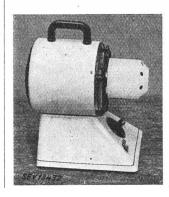
Beschreibung: Heizofen mit Ventilator gemäss Abbildung. Widerstandsspiralen auf sternförmigen Trägern aus Glimmer in Blechzylinder. Dahinter befindet sich ein Ventilator, angetrieben durch Einphasen-Kurzschlussankermotor. Temperatursicherung unterbricht Zuleitung einpolig, sobald infolge ungünstiger Ventilation zu hohe Temperaturen auftreten. Regulierschalter und Apparatestecker im Sockel eingebaut. Isolierhandgriff.
