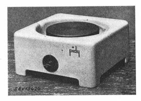
Beschreibung: Rechaud gemäss Abbildung. Gussplatte von 180 mm Durchmesser auf Eternitsockel. Heizwiderstand in Masse eingebettet. Regulierschalter und Apparatestecker im Sockel eingebaut.
