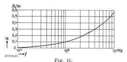
Widerstand des Leiters  $\left(R \text{ in } \frac{\Omega}{\text{m}}\right)$  in Funktion der Frequenz (f) Gleichstromwiderstand des Leiters = 0,005  $\frac{\Omega}{m}$
