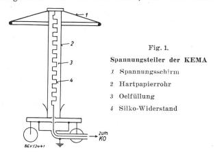
standsband hergestellt, ist in einem ölgefüllten Hartpapierzylinder eingebaut. An den beiden Enden des Messwiderstandes befinden sich die Elektroden zur Steuerung des Feldes, nämlich der spannungsführende Schirm und der geerdete Fuss.
