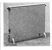
Beschreibung: Heizofen gemäss Abbildung. Widerstandsspiralen an zwei Eternitplatten befestigt. Diese sind übereinander im unteren Teil eines ventilierten Kastens aus Aluminiumblech eingebaut. Die Eternitplatten sind vom Gehäuse isoliert. An einer Stirnseite des Ofens ist ein Regulierschalter eingebaut. Für den Anschluss der Zuleitung ist ein Apparatestecker vorhanden.
