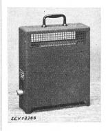
Beschreibung: Heizofen gemäss Abbildung. Widerstandsspiralen an der äusseren Seite von zwei nebeneinander aufgestellten Eternitplatten befestigt. Die Platten sind isoliert in ein Gehäuse aus Eisenblech eingebaut, welches unten durch ein Drahtgitter abgeschlossen ist. Kipphebel-Regulierschalter eingebaut. Apparatestecker für den Anschluss der Zuleitung. Handgriff aus Isoliermaterial.
