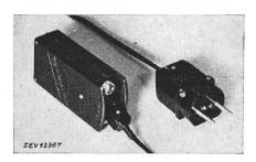
Wicklungen ist in ein Gehäuse aus Isolierpreßstoff eingebaut, welches mit Steckerstiften versehen ist. Diese ermöglichen das Anstecken des Transformators an normale zweipolige Steckdosen für 6 A 250 V. Die Primärwicklung ist für 110...125 V und 220 V umschaltbar. Für den Anschluss der Taschenlampe dient ein mit Apparatesteckdose versehener Leiter mit Thermoplastisolation.
