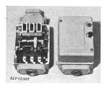
thermische Auslöser in allen 3 Polen. Abwälzkontakte aus Kupfer (für 15 A silberplattiert). Kontaktplatte, Kontaktwalze, Gehäuse der thermischen Auslöser und Druckknöpfe aus Isolierpreßstoff. Funkenkammern aus keramischem Material. Auslöser mit Schraubenzieher verstellbar. Gehäuse aus Stahlblech, innen und aussen mit Erdungsschrauben versehen. Auslöser für 0,25...0,45 A, 0,4...0,7 A, 0,6...1,1 A, 1...1,8 A, 1,6...2,8 A, 2,5...4,5 A, 4...7 A, 6...11 A und 10...15 A.
