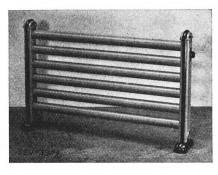
Beschreibung: Heizofen aus Leichtmetall, gemäss Abbildung. Widerstandsspiralen mit Glimmerisolation in Rohre eingezogen, welche durch zwei Stützen zusammengehalten werden. Füsse und Handgriffe aus Holz. Regulierschalter und Apparatestecker eingebaut.
