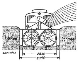
Fig. 1. Elektrische Schneeschleudermaschine der Brünigbahn Spurweite 1 m
