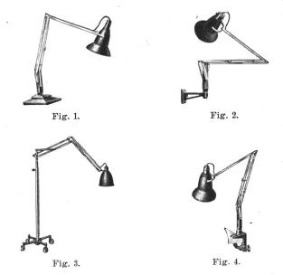
lampe (Fig. 3) und zum Anklammern (Fig. 4); es gibt noch verschiedene andere Modelle. Der Lampenträger ist ein dreiteiliges, leichtes Hebelsystem, welches in sinnreicher Weise durch Präzisions-Federn so verbunden ist, dass der Reflektor in jeder Lage im Gleichgewicht ist und sich durch ganz kleine Kräfte in jede beliebige Stellung bringen lässt. Die Konstruk-
