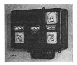
Fig. 2. Compteur «Décret-loi» (Landis & Gyr) comprenant un compteur d'énergie apparente en bas à gauche, un compteur d'énergie réactive en bas à droite avec le second cadran indicateur de maximum de l'énergie réactive en haut à droite.
