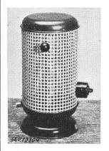
Beschreibung: Heizofen gemäss Abbildung. Widerstandsspiralen auf eine Eternitplatte gewickelt, welche mit einem Blechrahmen versehen ist. Die Platte ist, durch keramisches Material und Glimmer isoliert, in ein perforiertes Blechgehäuse eingebaut. Regulierschalter und zwei Isolierhandgriffe aufgebaut. Apparatestecker für den Anschluss der Zuleitung vorhanden.
