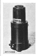
Beschreibung: Apparate zur Erzeugung von Ozon. Prüf-Nr. 1 gemäss Abbildung, Prüf-Nr. 2 mit grösserem Glaskolben und dementsprechend grösserer Blechhaube. Hochspannungs-Kleintransformator in dicht schliessendem Gehäuse aus Isolierpreßstoff. Glaskolben mit zwei Glimmelektroden und Schutzhaube aus Blech aufgesetzt. Kleinsicherung im Primärstromkreis des Transformators eingebaut. Für die Leitereinführung ist eine Stopfbüchse vorhanden.
