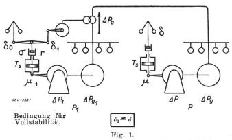
Neues Prinzip eines Primärreglers der Uebergabeleistung mit unabhängigem Nebeneinanderarbeiten des gewöhnlichen Drehzahlreglers mit einem Leistungssystem gibt Vollstabiltät unter Wegfall aller Vorrichtungen zum Auswiegen und Anpassen des Verhältniswertes Frequenz-Leistung der bisherigen Frequenz-Leistungs-Regler
