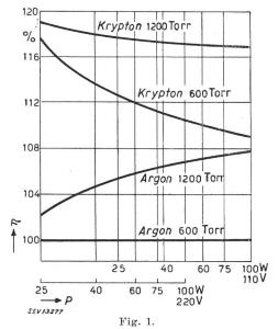
Lichtausbeute der Glühlampen  $\eta$  in Funktion der Leistung P Einflus des Füllgases bei gleicher Lebensdauer  $\eta$  Anfangslichtausbeute für gleiche Lebensdauer in % Stickstoff-Zusatz stets 10%
