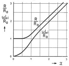
Fig. 5. Skineffekt am homogenen Runddraht
