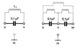
Fig. 12. Grobstörschutz durch Kondensatorbeschaltung
