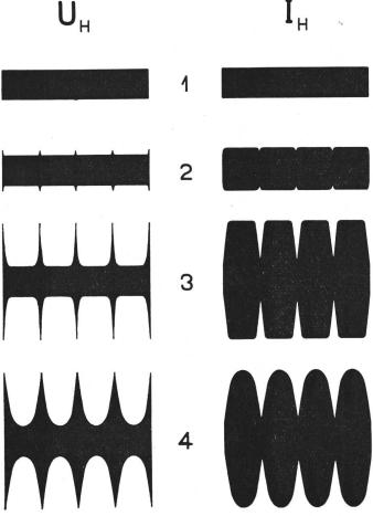
${\bf Fig.} \ \ 8. \\ {\bf Grundformen} \ \ {\bf der} \ \ {\bf Sekundärmodulation} \ \ {\bf im} \ \ {\bf Heizkrels}$
