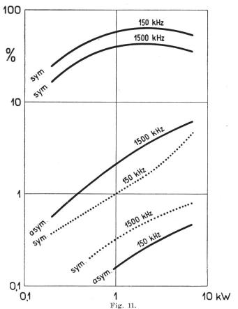
Störmodulationsgrad der Betriebsimpedanz eines mittleren Kochherdes
