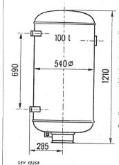
Beschreibung: Heisswasserspeicher für Wandmontage, gemäss Skizze. Ein Heizelement, ein Temperaturregler mit Sicherheitsvorrichtung und ein Zeigerthermometer eingebaut.
