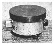
Beschreibung: Rechaud gemäss Abbildung. Gussplatte von 180 mm Durchmesser auf Sockel aus Aluminiumblech. Füsse aus Isoliermaterial. Heizwiderstand in Masse eingebettet. Regulierschalter im Sockel eingebaut, Apparatestecker aufgebaut.
