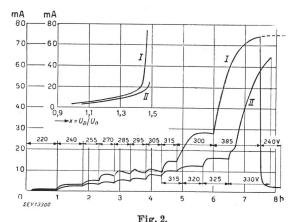
Treppen- und Ableitstromkurven einer Vollkoch-Platte (Prüfungsobjekt Nr. 5)
