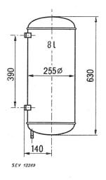
Beschreibung: Heisswasserspeicher gemäss Skizze, für Wandmontage. Ein Heizelement und ein Temperaturregler mit Sicherheitsvorrichtung eingebaut.
