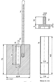
dünnwandige Eisenhülse passt, welche das zu prüfende, pulverisierte Material enthält. Die Eisenhülse wird mit einem Deckel verschlossen, welcher eine Düse für den Austritt der Gase trägt. Die Temperatur des Kupferblockes wird konstant gehalten und durch ein in eine Bohrung eingestecktes Thermometer gemessen.
