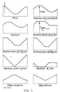
Räumliche Intensitätsverteilung im Flimmerbild c-Funktionen für die in Fig. 2 dargestellten Licht-Zeit-Kurven, berechnet für die Stelle S=2s
