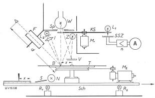
Fig. 1. Anordnung zur Untersuchung des Bewegungsflimmerns
