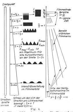
Theorie des Flimmerbildes eines weissen Streifens auf schwarzem Grund, der um einen seiner Punkte gedreht wird Die berechneten Intensitätsverteilungen c beziehen sich auf den Fall der symmetrischen Rechteckkurve
