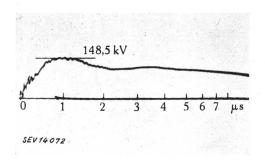
Fig. 6 Kathodenstrahl-Oszillogramm der Stoßspannung für den Versuch am 2000-kVA-Transformator Stoss am Stossgenerator ohne Prüfobjekt aufgenommen
