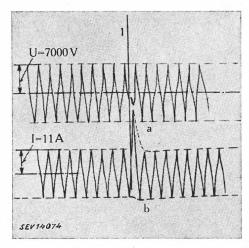
Fig. 8 Schleifen-Oszillogramm beim Stossversuch am 2000-kVA-Transformator
