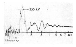
Fig. 7 Kathodenstrahl-Oszillogramm der Stoßspannung am 2000-kVA-Transformator Stoss am Prüfobjekt bei offener Kopplungsfunkenstrecke Fr Stoss 160 kV Durch Reflexion hervorgerufene Ueberspannungsspitze ca. 355 kV
