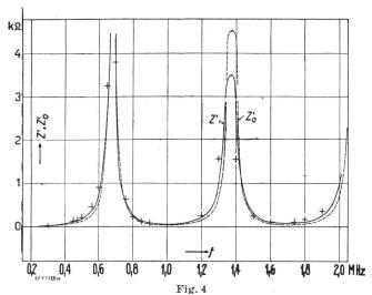
Realteil der Strahlungsimpedanz in Funktion der Frequenz Z' Realteil der Strahlungsimpedanz (Antennenverluste berücksichtigt). Zo' Realteil der Strahlungsimpedanz (Antennenverluste vernachlässigt). f Frequenz.
