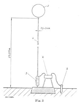
Messanordnung mit Ballonantenne 1 Antennendraht, 2 Ballon, 3 Isolator, 4 HF-Impedanzmessbrücke, 5 Erdpfahl.
