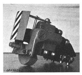
Fig. 3 Ansicht des pneumatischen Rückmelders
