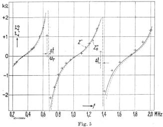
Imaginärteil der Strahlungsimpedanz in Funktion der Frequenz
