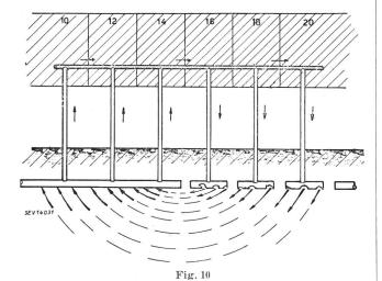
Zunahme der örtlichen Korrosionsangriffe nach dem Einbau isolierender Schraubmuffen
