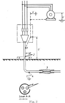
Die Gefahren bei Verwendung der Starkstromkabel-Bleimäntel als Erdelektrode
