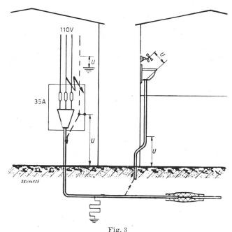
Die Gefahren bei Verwendung der Starkstromkabel-Bleimäntel als Erdelektrode
