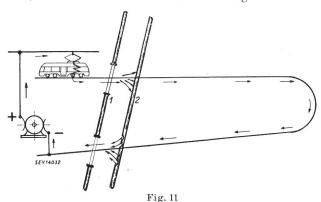
Wirksame Isolierung einer Wasserleitung gegen Korrosionsangriffe durch Einfügen eines genügend langen Rohrstückes aus Eternit
