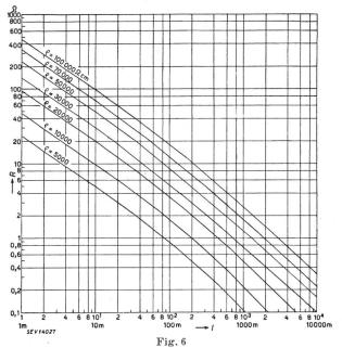
Erdübergangswiderstände R blanker Rohrleitungen in Abhängigkeit von der Elektrodenlänge l bei verschiedene spezifischen Erdübergangswiderständen e des Erdbodens Berechnung der Kurven:
