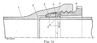
Elektrisch überbrückte Schraubmuffe
