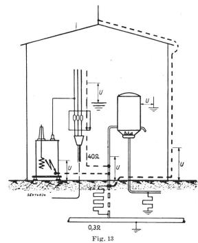
Unterbrechung einwandfreier Erdungen infolge Einbaus isolierender Schraubmuffen
