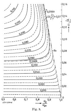
7. Netzstromoberwelle in Abhängigkeit der induzierten Gleichspannung  $rac{U_{f q}}{U_{f qo}}$  und des induktiven Gleichspannungsabfalles  $riangleq rac{I_{f q}}{I_{f qn}}$
