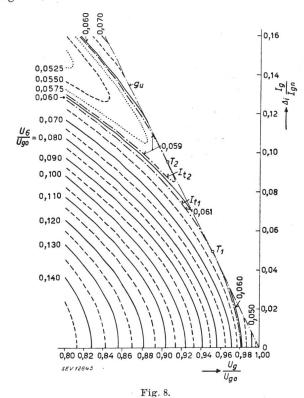
6. Gleichspannungsoberwelle in Abhängigkeit der induzierten Gleichspannung  $\frac{U_{\rm Q}}{U_{\rm Q0}}$  und des induktiven Gleichspannungsab-
