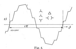
Verlauf des Netzstromes i von Schaltungen mit zweischenkliger Saugdrosselspule
