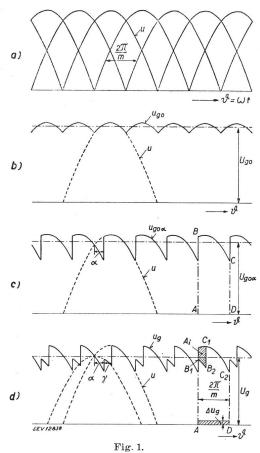
Verlauf der Gleichspannung
