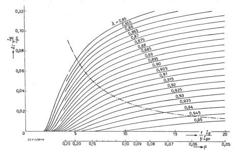
Fig. 7. Leistungsfaktor  $\lambda$  in Abhängigkeit des induktiven Gleichspannungsabfalles  $\triangle_i \frac{I_g}{I_{gn}}$  und des Ausdruckes  $\frac{1}{\mu} \frac{I_{g}}{I_{gn}}$  (unregulierter Betrieb) Verhältnis des Magnetisierungsstromes zur Grundwelle des ideellen Netzstromes.
