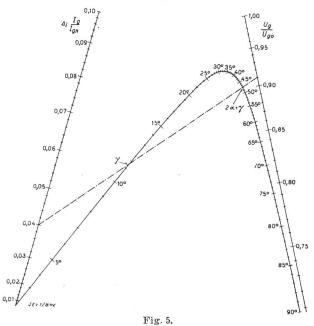
Nomogramm zur Bestimmung der Ueberlappung  $\gamma$  und des Steuerwinkels  $\alpha$  in Abhängigkeit der induzierten Gleichspannung  $\frac{U_0}{U_{00}}$  und des induktiven Gleichspannungsabfalles  $\triangle_i$   $\frac{I_0}{I_{00}}$   $U_0$ ,  $U_0$ . Mittelwerte der induzierten Gleichspannung bzw. der Leerlaufgleichspannung.  $\triangle_i$  induktiver Gleichspannungsabfall bei Nennstrom.  $I_0$ ,  $I_{00}$  Gleichstrom bzw. Nenngleichstrom.
