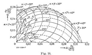
Vektordiagramm der 5. Anodenstromoberwelle (Saugschaltung) Ortskurven konstanten Steuerwinkels  $\alpha$  und konstanten Summen winkels «Steuerwinkel  $\alpha$  + Ueberlappung  $\gamma$ »
