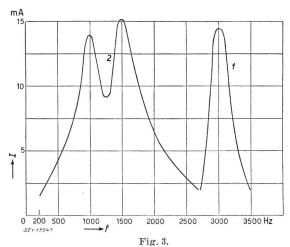
Courants I dans les relais de signalisation (1) et de garde (2) en fonction de la fréquence f
