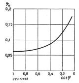
Fig. 5. Erreur globale réduite par l'interversion des thermocouples
