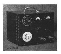
Der Transformator hat die Prüfung in sicherheitstechnischer Hinsicht bestanden. Verwendung unter Beachtung der «Leitsätze zur Vermeidung von Schäden beim Auftauen von Wasserleitungen an Gebäuden» (Publ. Nr. 162).
