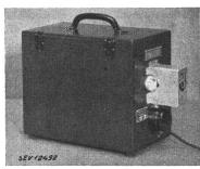
Beschreibung: Apparat gemäss Abbildung zum Trocknen von Materialproben in Laboratorien. In  $170\times300\times250$  mm grossem ventiliertem und mit Asbest und Glanzeternit ausgekleidetem Sperrholzkasten sind zwei Kohlefadenlampen und ein Temperaturregler eingebaut. Der Temperaturregler ist verstellbar. Zur Aufnahme des Trockengutes befindet sich oben im Kasten ein Drahtgitter. Netzanschluss mit zweiadriger, mit Stecker versehener Rundschnur. Einpoliger Kipphebelschalter angebaut.
