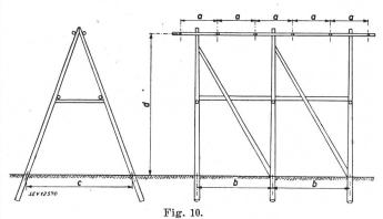
Skizze der Abspannböcke am Daubensee a=2.64 m b=5.40 m c=7.50 m d=10.00 m
