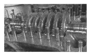
Fig. 4. Hochdruckturbine abgedeckt  $n=8000/\mathrm{min}$ .
