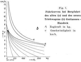
und ohne jeden Zugkraftunterbruch abwickelt. Die Parallelschaltung der Batterieelemente ist vermieden. Fig. 5 stellt das Prinzipschema des alten Traktors, Fig. 6 dasjenige des neuen dar. Die entsprechenden Charakteristiken sind in Fig. 7 und 8 wiedergegeben.
