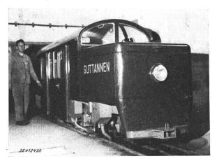
Fig. 4. Akkumulatoren-Triebwagen für 500-mm-Spur, Linie Guttannen - Handeck
