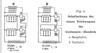
radgetriebe und Zulassung einer höheren Drehzahl. Die übrige frühere Apparatur war aber zu voluminös und konnte nicht unter der mittleren Sitzbank placiert werden. Da dies der einzige Ort war, der zur Verfügung stand, musste die Apparatur neu konstruiert werden. Dabei wurde die Schaltung so geändert, dass das Aufschalten sich regelmässiger
