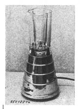
Beschreibung: Mischmaschinen (Mixer) gemäss Abbildung, mit ventiliertem Einphasen-Seriemotor. Das in ein Glasgefäss eingebaute Rührwerk wird durch eine mit dem Motor elastisch verbundene Achse angetrieben. Schalter mit Anlaufstufe eingebaut. Netzanschluss mit dreiadriger, mit 2P+E-Stecker versehener Zuleitung.
