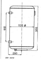
Beschreibung: Heisswasserspeicher für Wandmontage gemäss Skizze. Ein Heizelement, ein Temperaturregler mit Sicherheitsvorrichtung und ein Zeigerthermometer eingebaut. Erdungsklemme vorhanden.
