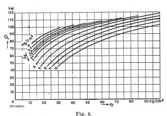
Gegendruck-Dampfmaschinen SLM-Winterthur Erzeugbare Leistung P für einen Dampfdurchsatz von 1000 kg/h in Abhängigkeit von Frischdampfdruck  $p_{\text{f}}$  und Gegendruck  $p_{\text{g}}$
