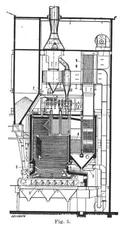
Sulzer-Hochdruck-Einrohrkessel von 55 t/h, 140 kg/cm<sup>2</sup> abs. Druck, 500° C
