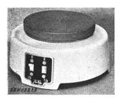
Beschreibung: Rechaud gemäss Abbildung. Guss-platte von 180 mm Durchmesser auf emailliertem Gußsockel. Heizwiderstand in Masse eingebettet. Zwei Kipphebelschalter und Apparatestecker im Sockel eingebaut.
