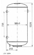
Beschreibung: Heisswasserspeicher für Wandmontage gemäss Skizze. Ein Heizelement, ein Temperaturregler mit Sicherheitsvorrichtung und ein Zeigerthermometer eingebaut.
