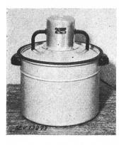
Beschreibung: Waschmaschine gemäss Abbildung. Am Deckel des Wäschebehälters aus Aluminium ist ein Einphasen-Kurzschlussankermotor befestigt, welcher über ein Getriebe die im Behälter stehende Waschvorrichtung antreibt. Letztere führt Drehbewegungen in wechselnder Richtung aus. Der Motor ist in ein Gehäuse mit Innenventilation eingebaut, und für eine Betriebsdauer von 15 Minuten dimensioniert.
