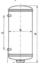
Beschreibung: Heisswasserspeicher für Wandmontage, gemäss Skizze, mit einem Heizelement und einem Temperaturregler mit Sicherheitsvorrichtung.
