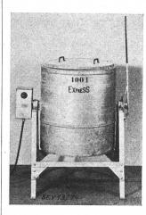
Beschreibung: Futterkocher gemäss Abbildung, aus verzinktem Eisenblech, auf Gestell zum Kippen eingerichtet. Seitenheizung. Klemmenkasten und Regulierschalter seitlich angebracht. Dreiadrige Zuleitung (2P+E) fest angeschlossen. Isolierhandgriffe an der Kippstange und am Deckel.
