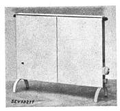
Beschreibung: Heizofen gemäss Abbildung. Heizwiderstand in zwei Eisenrohre eingezogen und diese, zu einer einfachen Schlaufe gebogen, im unteren Teil eines ventilierten Kastens (Heizwand) aus Aluminiumblech eingebaut. Regulierschalter und Apparatestecker an einer Stirnseite unten angebracht.
