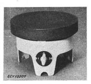
Beschreibung: Rechaud gemäss Abbildung. Gussplatte von 193 mm Durchmesser auf unten mit Blech abgeschlossenem Sockel aus Leichtmetallguss. Widerstandsdraht in Masse eingebettet. Regulierschalter unter dem Sockel. Apparatestecker aufgebaut.
