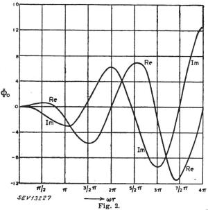
von der Frequenz abhängige Anteil der Funktion  $\Phi_0$  in einem unendlich ausgedehnten Transversalfeld in Abhängigkeit von  $\omega \tau$  Im Imaginärer Anteil.
