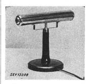
Beschreibung: Apparat gemäss Abbildung, zum Regenerieren von Kohlepapier mit Wärme. Heizelement in vernickeltes Metallrohr eingebaut und auf Holzsockel befestigt. Zuleitung zweiadrige Rundschnur mit Stekker, fest angeschlossen. Das zu regenerierende Kohlepapier wird über den Apparat gezogen.
