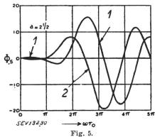
Ein typisches Beispiel für die Darstellung des komplexen Ablenkungskoeffizienten  $\phi s$  in einem sinusförmigen Ablenkfeld. a=2,51 Reell. 2 Imaginär.
