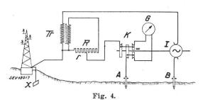
Prinzipschema eines Erdwiderstandsmessers
