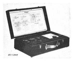
Fig. 7. Bürdenmesser für Strom- und Spannungswandlerbürden
