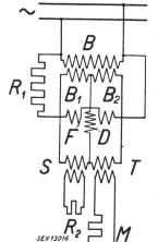
Fig. 3. Prinzipschema einer Wechselstrom-Brückenschaltung mit induktiven Zweigen
