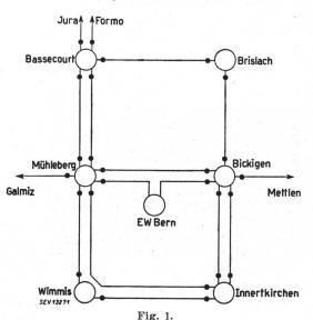
Schnelldistanzschutz im 150-kV-Netz der BKW Die schwarzen Punkte stellen Hochspannungsschalter mit Schnelldistanzrelais dar.
