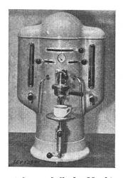
Beschreibung: Kaffee. maschine gemäss Abbildung, mit vom Wasser isoliertem Heizelement. Wasserbehälter, dessen Inhalt durch das Heizelement und einen Druck-regler unter Druck auf Temperaturen über 100°C gehalten wird. Armaturen für Kaffeezubereitung, sowie Heisswasser- u. Dampfentnahme, ferner ein Sicherheitsventil, ein Manometer, ein Wasserstandanzeiger und eine Sicherheitsvorrichtung gegen Ueberhitzung vorhanden.
