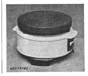
Beschreibung: Rechaud gemäss Abbildung. Gussplatte von 180 mm Durchmesser auf Blechsockel mit Füssen aus Isolierpreßstoff. Heizwiderstand in Masse eingebettet. Kipphebelregulierschalter und Apparatestecker im Sockel eingebaut.
