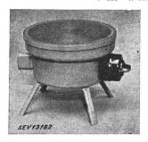
Beschreibung: Rechaud gemäss Abbildung. Gussplatte von 198 mm Durchmesser auf Blechsockel. Widerstandsdraht in Masse eingebettet. Regulierschalter und Apparatestecker aufgebaut.
