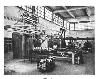
Fig. 9. Elektro-Brennofen-Anlage in einem schweizerischen Emaillierwerk
