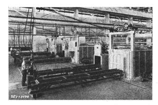
Fig. 12. Amerikanische Elektro-Emaillierofen-Anlage mit 3 Kammeröfen von je 260 kW
