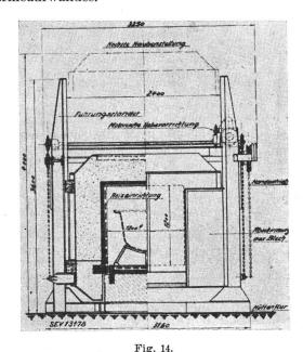
Spezial-Elektro-Emaillierofen für das Einbrennen von grossen gusseisernen Waschkesseln nach dem Puderverfahren Haubenofen mit rundem Ofenraum,  $\varnothing$  1,2 m. Anschlusswert 120 kW.
