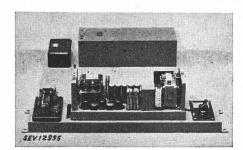
Beschreibung: Apparat gemäss Abbildung, zur Steuerung von Stahltonmaschinen, mit welchen Telephongespräche auf
