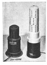
Beschreibung: Apparate zur Erzeugung von Ozon, gemäss Abbildung, bestehend aus einem Hochspannungs - Kleintransformator und einem Glaskolben mit zwei Glimmelektroden. Gehäuse aus Isolierpreßstoff, Schutzhaube aus Blech. Im Primärstromkreis des Transformators ist eine
