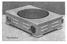
Beschreibung: Rechaud gemäss Abbildung. Gussplatte von 180 mm Durchmesser in Blechsockel versenkt eingebaut. Widerstandsdraht in Masse eingebettet, Regulierschalter eingebaut, Apparatestecker aufgebaut.
