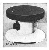
Beschreibung: Rechaud gemäss Abbildung. Gussplatte von 220 mm Durchmesser auf 130 mm hohem Blechsockel. Widerstandsdraht in Masse eingebettet. Regulierschalter im Sockel eingebaut, Apparatestecker aufgebaut.
