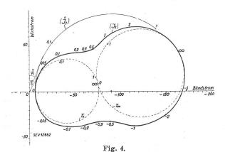
Stromdiagramm des Doppelkäfigmotors
