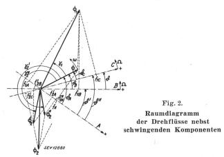
duzieren, die, abgesehen von den geringen Ohmschen und induktiven Spannungsverlusten in dieser Wicklung, der aufgedrückten Klemmenspannung das Gleichgewicht halten muss. Man kann  $\Phi$  als den resultierenden Drehfluss der (fiktiven) Komponenten  $\Phi_1$ ,  $\Phi_2'$ ,  $\Phi_2''$ , welche von den Drehamperewindungen der Ständerwicklung bzw. des inneren und des äusseren Käfigs erzeugt werden, bezeichnen.
