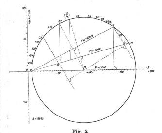
Stromdiagramm des Einkäfigmotors
