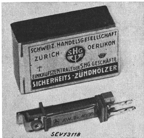
Fig. 5. Miniaturrelais des Impulswiederholers (Grössenvergleich mit einer Streichholzschachtel)
