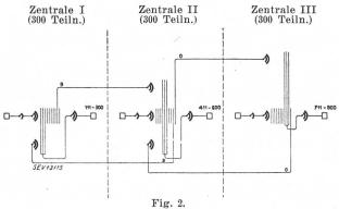
Netz einer Nebenstellen-Anlage für 3 Betriebe; Schaltung mit offener Kennziffer
