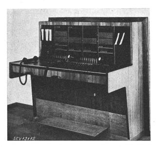
Fig. 12. Schrank mit Universalschnüren und Einschleifenrückfragesystem für Grossbetriebe
