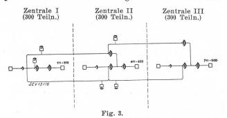
Netz einer Nebenstellen-Anlage mit 3 Zentralen; Schaltung mit verdeckter Kennziffer und blind mitlaufenden Wählern
