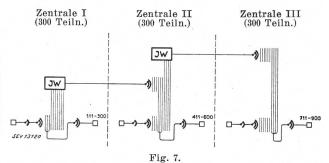
Netz einer Nebenstellen-Anlage mit 3 Zentralen; Schaltung mit verdeckter Kennziffer und Impulswiederholer
