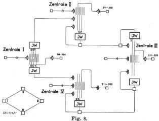
Aus 4 Zentralen bestehendes Netz in Ringschaltung; Direkt- und Umwegverkehr mit Impulswiederholer
