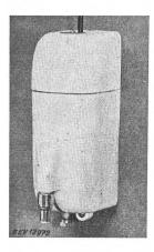
Beschreibung: Durchlauferhitzer aus keramischem Material für Wandmontage gemäss Abbildung. Kohleelektroden in Verbindung mit dem durchfliessenden Wasser. Elektroden zwecks Reinigung leicht zugänglich. Dreiadrige Zuleitung fest angeschlossen.
