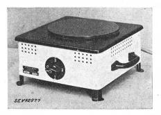
Beschreibung: Rechauds gemäss Abbildung. Gussplatte von 180 mm Durchmesser auf 123 mm hohem Blechsockel. Widerstandsdraht in Masse eingebettet. Regulierschalter eingebaut. Dreiadrige Gummiaderschnur mit 2P+E-Stecker fest angeschlossen.
