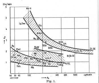
Erzeugungskosten der Winterenergie ab bestehenden Kraftwerken (Wert der Sommerenergie: 1 Rp./kWh)
