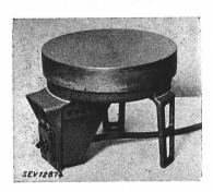
Beschreibung: Rechaud gemäss Abbildung. Gussplatte von 180 mm Durchmesser auf Gußsockel. Heizwiderstand in Masse eingebettet. Kipphebel-Regulierschalter in Blechverschalung. Als Zuleitung dient eine fest angeschlossene Apparateschnur mit 2 P+E-Stecker.
