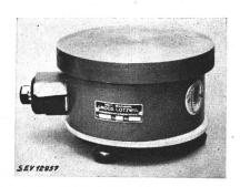
Beschreibung: Rechaud gemäss Abbildung. Gussplatte von 220 mm Durchmesser auf unten mit Eternit abgeschlossenem Blechsockel. Heizwiderstand mit Glimmerisolation durch Gussplatte angepresst. Regulierschalter aufgebaut. Versenkter Apparatestecker für den Anschluss der Zuleitung.
