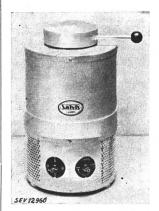
Beschreibung: Tiegelofen gemäss Abbildung, mit zylindrischem Glühraum von 120 mm Durchmesser und 105 mm Tiefe. Gehäuse aus Eisenblech. Im Unterteil ist ein Transformator mit zusammenhängenden Wicklungen und Anzapfungen eingebaut. Mit Hilfe eines Regulierschalters kann die Spannung am Heizwiderstand bzw. die Heizleistung verändert werden. Für den Anschluss der Zuleitung sind feste Klemmen vorhanden.
