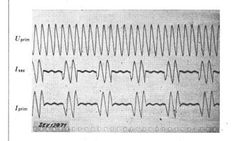
Avec condensateur série Fig. 7. Soudeuse avec interrupteur synchrone
