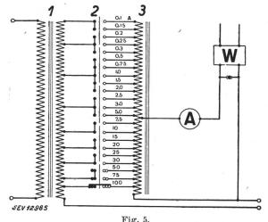
Anschlußschema zum Präzisionsstromwandler mit 22 Messbereichen nach Fig. 4
