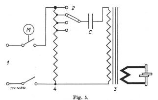
Schéma d'une soudeuse avec condensateur série
