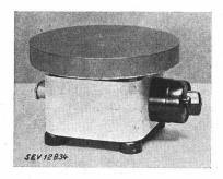
Beschreibung: Rechaud gemäss Abbildung. Gusskochplatte von 200 mm Durchmesser auf unten mit Eternit abgeschlossenem Blechsockel. Heizwiderstand in Masse eingebettet. Regulierschalter und Apparatestecker aufgebaut.
