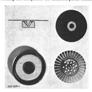
Fig. 4. Mikrophon mit kegelförmiger Elektrode (Lorenz)
