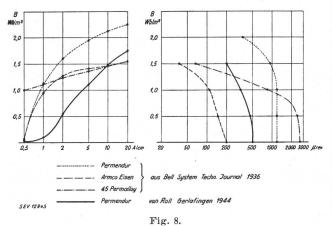
Magnetisierungskurven und Abhängigkeit der reversiblen Permeabilität von der Gleichflußsättigung für verschiedene Membranbleche
