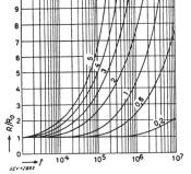
Fig. 3 Widerstandszunahme durch Skineffekt für Drahtstärken von 0,2...5 mm Ø
