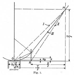
Ideelles Potentialdiagramm für den Polwinkel  $b/_{ au}=0,66$
